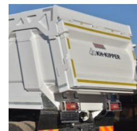
Lavan korotettu takaosa estää materiaalin putoamisen jyrkissä nousuissa
