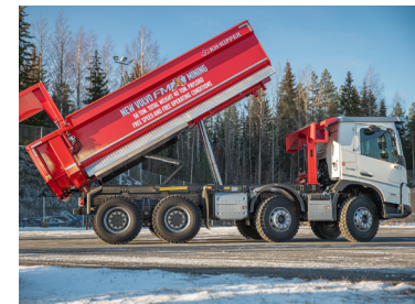
Ohjaamon katolla alumiinisuoja sekä kivränni ohjaamon ja lavan välissä
