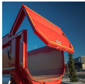
Ainutlaatuinen \Omega -muoto varmistaa suuremman tilavuuden ja matalamman painopisteen
