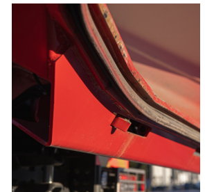
Perälaudassa tiiviste ja 2 kappaletta lukkoja, erittäin tiivis
