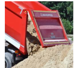
Optimaalisesti muotoillut lavan kulmat
